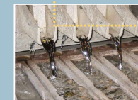
Aluminium udledes fra karret med jævne mellemrum.
